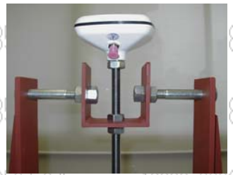
クレーン先端設置金具
